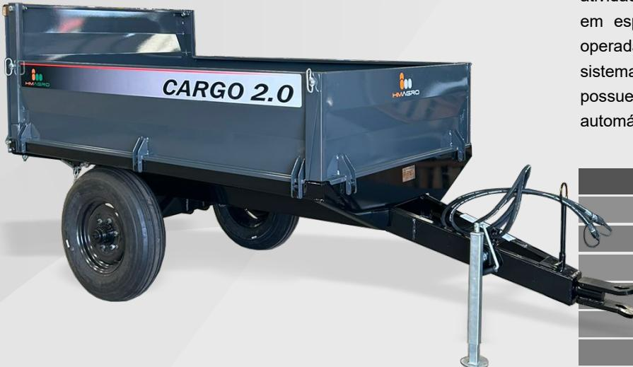
A Cargo 2m<sup>3</sup> foi desenvolvida para ser utilizada nas mais variadas atividades no campo. Ideal para transporte e descarga de grãos, em especial o café, por possuir largura reduzida e poder ser operada com trator de pequeno porte entre 25cv e 30cv. Possui um sistema hidráulico para realizar o basculamento, as laterais possuem tampas dobráveis e a tampa traseira possui um desarme automático.
